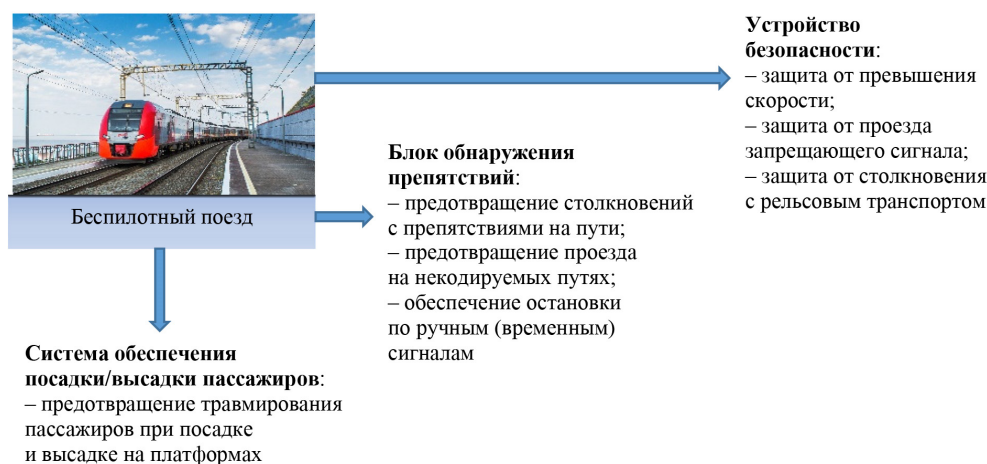
Рис 1. Системы обеспечения безопасности беспилотного поезда
